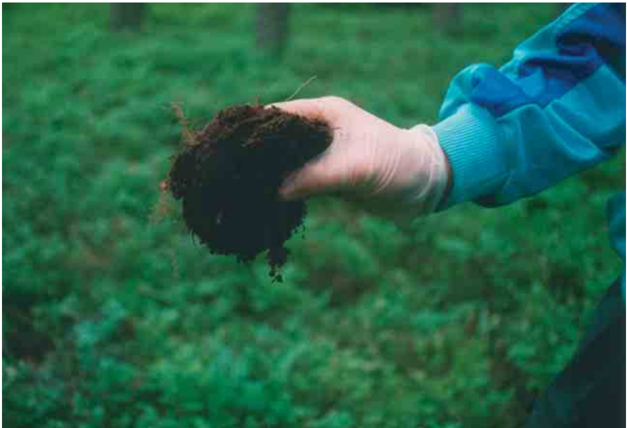
Kuva 5. Humusnäyte näytteenottimen terässä (a) ja siitä erotettu analyysiin menevä osa (b). Valokuva: Timo Tarvainen. Fig. 5. Humus sampling using cylinder sampler (a) and final humus sample for analysis (b). Photograph: Timo Tarvainen
